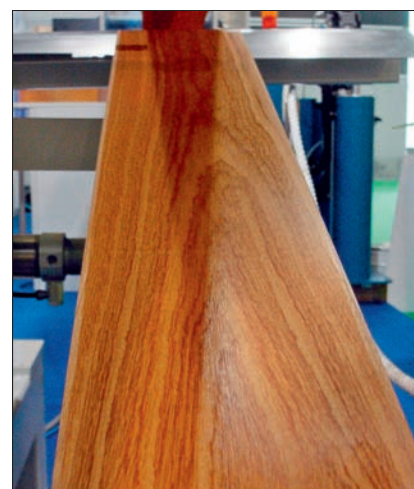
Die „Veredelung“ der Furniere im „Hot-Coating“-Verfahren.
