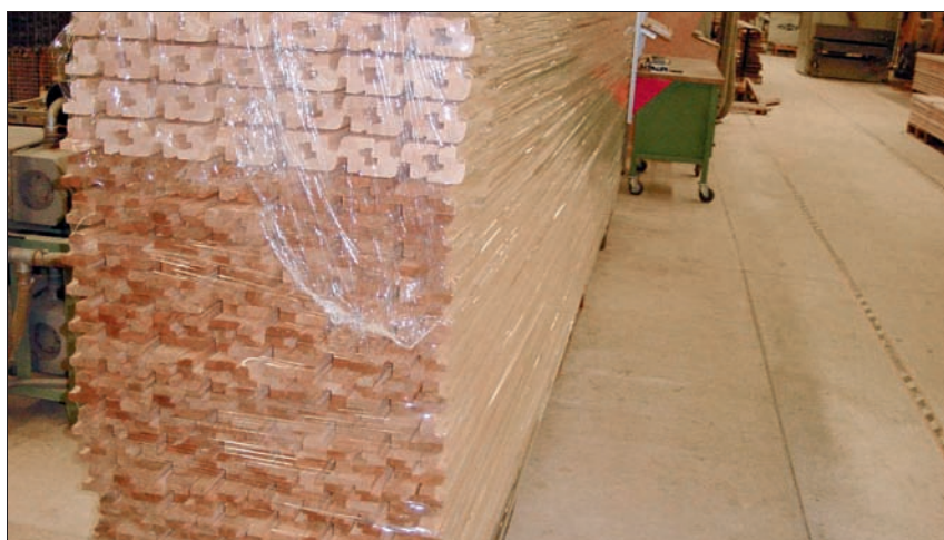
Die fertig konfektionierten und oberflächenbehandelten Rahmenhölzer werden „just-in-time“ geliefert.
