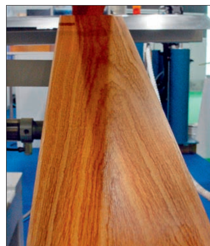
Die „Veredelung“ der Furniere im „Hot-Coating“-Verfahren.
