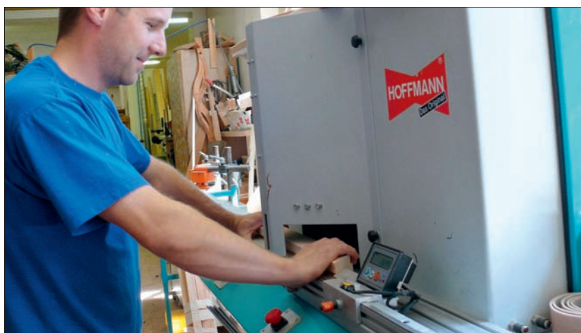
Zur Herstellung der Rahmen und Flügel genügen eine Doppelgehrungssäge zum Ablängen der Kanteln...
